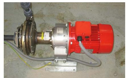
Die Fütterung selber erfolgt über eine drehzahlgeregelte zweistufige Kreiselpumpe. Diese ist Trockenlauf- und Fremdkörperunempfindlich und zeichnet sich trotz hoher Pumpenleistung durch den besonders niedrigen Verschleiß aus.
