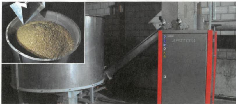
Maissilage in einer SPOTMIX- Fütterungsanlage grammgenau mit anderen Futtermitteln vermischt und an jeden Einzeltrog verteilt werden kann. Sogar die genaue Dosierung in einer COMPIDENT- Abruffütterung ist gelöst.
