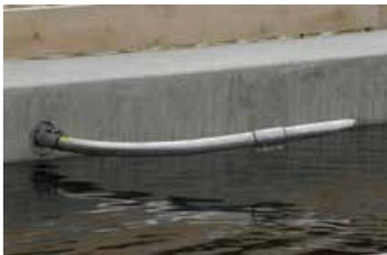
Werkzeuglos abnehmbarer Futterauswurf am Maueranschluss
