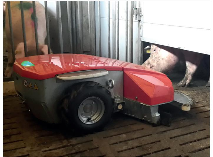
**Der wendige und kompakte Entmistungsroboter ENRO reinigt bis zu 1000 m<sup>2</sup> Spalten- oder Festboden pro Tag mit sehr hoher Betriebssicherheit.**
